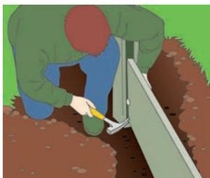
Die Motivseite der Platte wird nun an den Pfosten angedrückt und die entstehende Fuge mit einem Stein verkeilt. Bei doppelseitiger Bauweise werden zwei Platten gegeneinander platziert. Das Verkeilen erfolgt zwischen den Platten.
