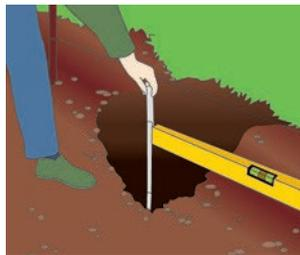
Zur Befestigung der Pfosten werden lediglich Punktfundamente erstellt. Für das Einbringen des Fundamentes zum Setzen des Anfangspfostens wird das erste Erdloch L:80/B:40/T:90 cm ausgehoben. Damit wird eine frostsichere Gründung garantiert.
