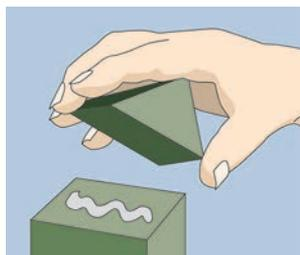
Im Anschluss werden die Wände gesäubert (staubfrei und trocken). Evtl. können Zubehörteile (Pfostenkappen) mit Flieskleber montiert werden.
