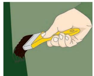
Dann sollte der Betonzaun je nach Wunsch mit Farbe behandelt werden, um den Beton dauerhaft zu schützen und ein volles Farbbild zu erhalten. Das beste Ergebnis erzielt man mit einem Lackiergerät. Die Farbe gut aufrühren und mit 10% Wasser verdünnen. Es sind zwei Arbeitsgänge nötig. Ergiebigkeit ca. 0,4 Liter/qm.
