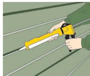
Zum Abschluss sollten die Zwischenräume der einzelnen Plattenelemente mit einem Aussenacryl versiegelt werden, um eine blickdichte und einheitlich geschlossene Optik zu erhalten. Für die Abschlussarbeiten ist eine Außentemperatur von mind. 14°C erforderlich!
