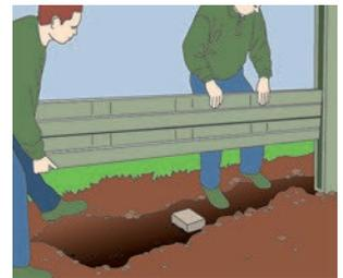
Die erste Betonplatte wird nun nach gewünschter Flucht in die Nut des Pfostens eingesetzt. Das Ende der Platte mit einem stabilen Pflasterstein als stabile Auflage unterlegen, so dass die Platte genau in Waage ist und fest aufliegt.
