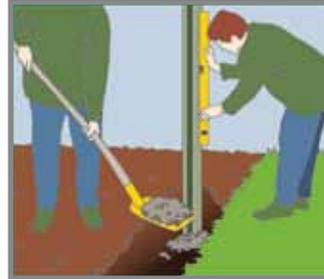
Die einzelnen Betonelemente werden immer waagrecht montiert. Der Anfangspfosten wird einbetoniert (Kies, Sand-Zement-Gemisch - Betongüte C16/20 - erdfeucht). Dabei ist besonders auf lotgenaues Ausrichten des Randpfostens zu achten.
