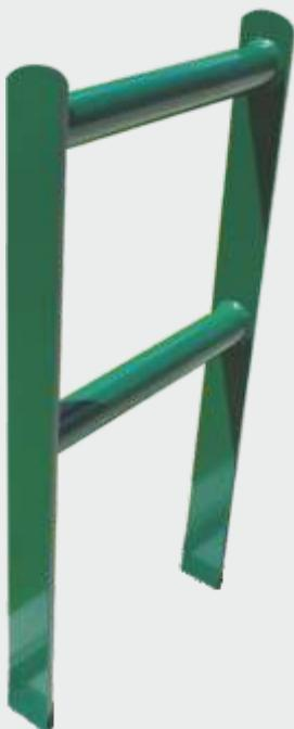
Einzelständer aus feuerverzinktem Flacheisen 80 x 12 mm, mit zwei eingeschweißten Rundrohren Ø 60 x 2,5 mm.
