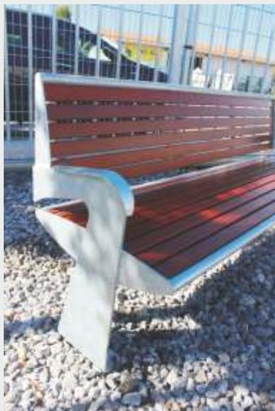
Elegante und schwere Bank aus feuerverzinktem Stahlgestell, zum Aufdübeln oder Einbetonieren. Seitenteile lasergeschnitten aus 5 mm Flachstahl. Die Holzbelattung erfolgt wahlweise in Eiche oder Robinie. Bei der Lasur wählen Sie zwischen Natur, Nußbaum oder Kirschbaum. Wir fertigen diese Bank als Einsitzer, Zweisitzer oder Dreisitzer, als Hockerbank oder mit Rückenlehne. Gegen Aufpreis ist eine Pulverbeschichtung in RAL- oder DB-Farben möglich.
