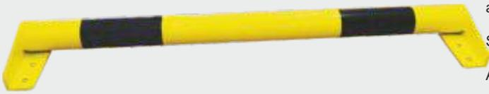
Rammschutzbalken zum Aufdübeln, aus Stahlrohr, Ø 60 mm oder Ø 76 mm, auf Winkelisen verschweißt und formschön gerundet.
