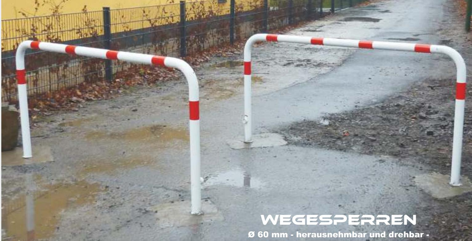
Wegesperre, bestehend aus einem Absperrbügel, der auf einer Seite lose 300 mm in einer Bodenhülse sitzt und auf der anderen Seite 200 mm in einer Bodenhülse verriegelt. Die verriegelte Seite ist herausnehmbar durch DIN Dreikantschließung, so dass sie im losen Bodenhülseenteil gedreht werden kann. Zum Lieferumfang gehören die beiden Bodenhülsen.
