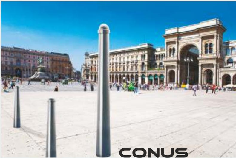
Stilpoller aus feuerverzinktem Stahl, konisch von 102 mm auf 76 mm zulaufend. Den Kopfabschluß bildet eine aufgeschweißte Halbkugel mit Zierring.
